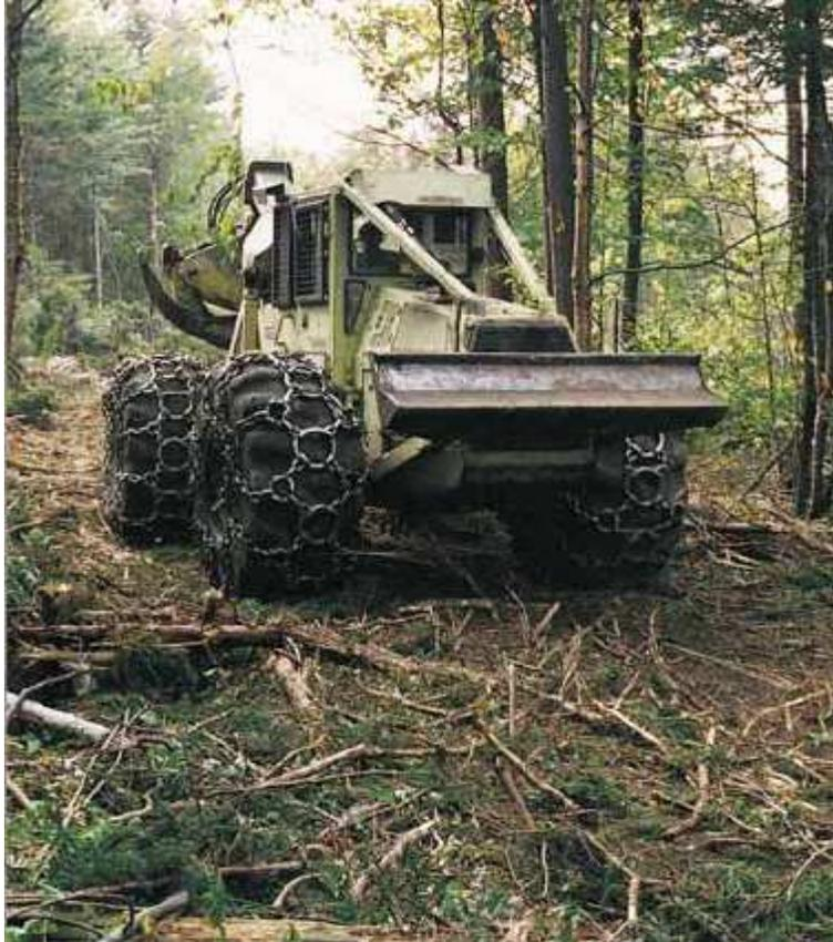
***Les broussailles sur les pistes de débardage, de même que le sol gelé, permettent de réduire la perturbation du sol et l'orniérage.***
